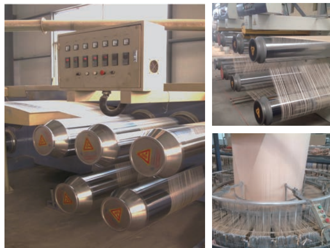
〈フィルムを短冊状にカットし、巻き取る工程〉
