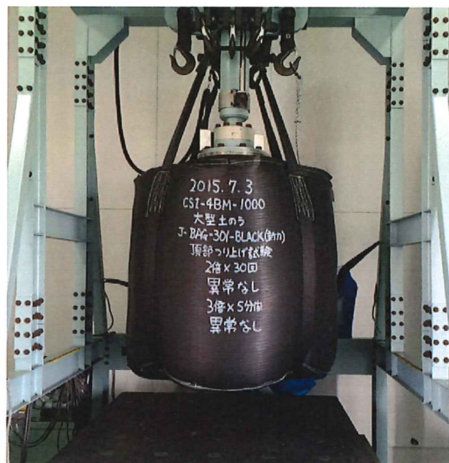
頂部吊り上げ試験
